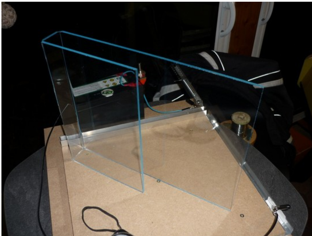
Photo de la plieuse en phase de prototypage, alimentée par batterie avec fil de 25cm !
